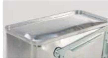
Der Boden ist stark deformiert, aber nicht aus dem Profil gesprungen. Die Deckelverriegelung hielt dem Aufprall-Test stand, der Schließzylinder hat sich gelöst.
