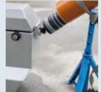
**Das 4-kg-Gewicht schlug aus 2 m Höhe schräg auf und bringt bei einigen Koffern zu schwach ausgelegte Verriegelungen bzw. Deckelprofile ans Licht.**
