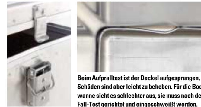
Beim Aufpralltest ist der Deckel aufgesprungen, die Schäden sind aber leicht zu beheben. Für die Bodenwanne sieht es schlechter aus, sie muss nach dem Fall-Test gerichtet und eingeschweißt werden.
