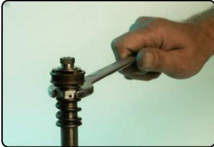
Kolbenstange auf Höhe des Hydraulik-Stops in Spanneisen spannen.
