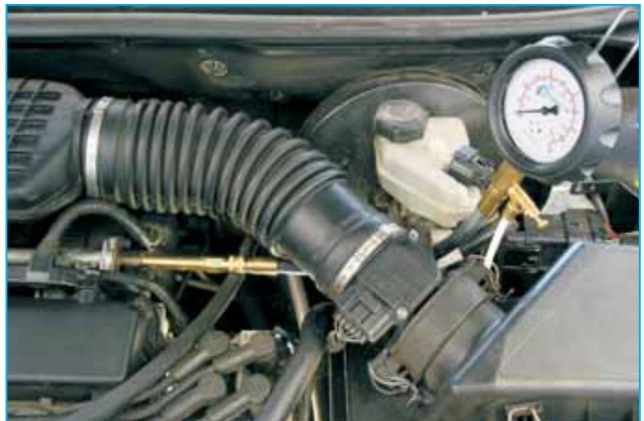
Abb. 83 Anwendung Kraftstoffdruck-Prüfgerät 4.07360.51.0
