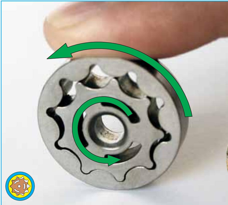
Abb. 52 Ein Trochoiden-Pumpenwerk muss leichtgängig ineinander abrollen
