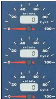
Im Test Modus **sind nur die 3 kleinen Anzeigen** der Instrumententafel aktiv und geben den Wert des Saugrohrunterdrucks des entsprechenden Zylinders an (nur bei Keihin), was eine Synchronisierung der Drosselklappen ermöglicht.
