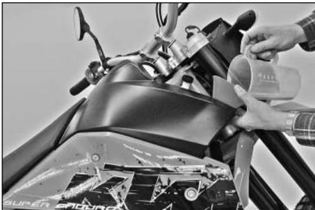
Füllen Sie den Kühler zur Gänze mit Kühlflüssigkeit auf. Kühlerverschluss montieren und Motorrad wieder in waagrechte Position bringen. Füllen Sie den Ausgleichsbehälter mit Kühlflüssigkeit auf bis sich der Pegel zwischen der MIN und MAX Markierung befindet und verschließen Sie den Ausgleichsbehälter.
