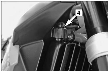
Als Kühlflüssigkeit wird eine Mischung von 50 % Frostschutzmittel und 50 % destilliertes Wasser verwendet. Der Gefrierschutz muss jedoch mindestens  $-25^{\circ}\text{C}$  betragen. Diese Mischung bietet neben Gefrierschutz auch einen guten Korrosionsschutz und sollte deshalb nicht durch reines Wasser ersetzt werden.
