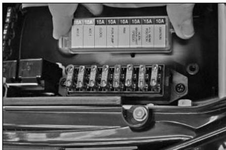
Durchgeschmolzene Sicherung nur durch eine gleichwertige ersetzen. Schmilzt nach dem Einsetzen einer neuen Sicherung diese wieder durch, unbedingt eine autorisierte KTM Fachwerkstätte aufsuchen.
