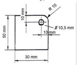
• Scharnierhälfte 2 rampenseitig (Nr.19 - Flachstahl 60mm x 20mm x 25mm)
