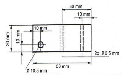
• Haltelaschen für Spanngurte (Nr.36 - Flachstahl 50mm x 20mm x 20mm)
