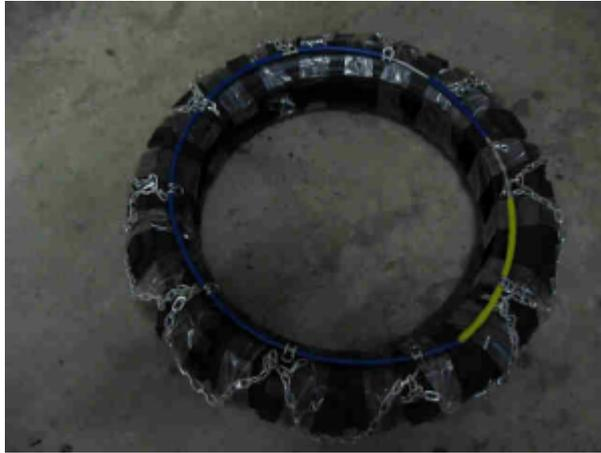
Die zweite Kette sollte man komplett zerlegen, d.h. die Endverbinder am Stahlseil aufbiegen und Röhrchen rausnehmen. Nun hat man genügend Material, um die passenden Stücke anzufertigen. Wenn die Röhrchen fertig sind, kann man damit beginnen, die Kettensegmente am Stahlseil zu befestigen. Hierzu die Klammern ->
