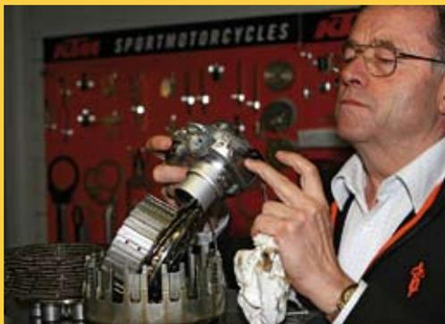
**Der Zustand jedes Details, hier die zerlegte Kupplung, wird von Ingenieur Franz Haslinger mit der Kamera dokumentiert.**
