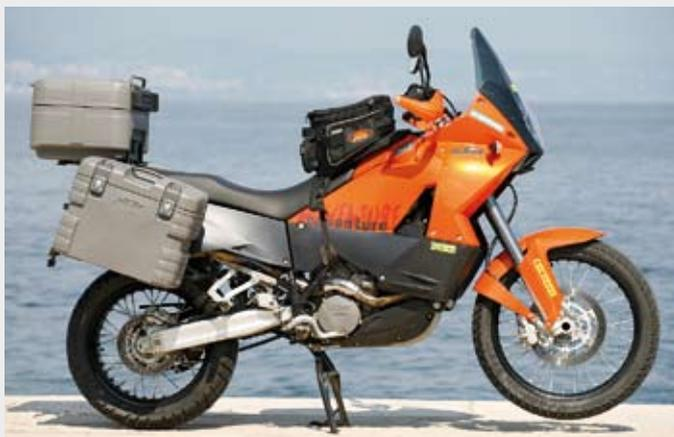
**Dass die Adventure mit montierten Koffern und Topcase ziemlich hecklastig wird, ist auf diesem Foto unschwer zu erkennen. Ebenfalls zu sehen ist, wie hoch die Koffer sitzen. Der Tankrucksack stört beim Fahren nicht.**
