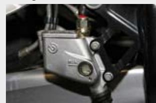
**Seit der Montage eines neuen Hauptbremszylinders für die hintere Scheibenbremse funktioniert diese einwandfrei. Das ursprünglich verwendete Bauteil wurde zum Hersteller Brembo eingeschickt.**
