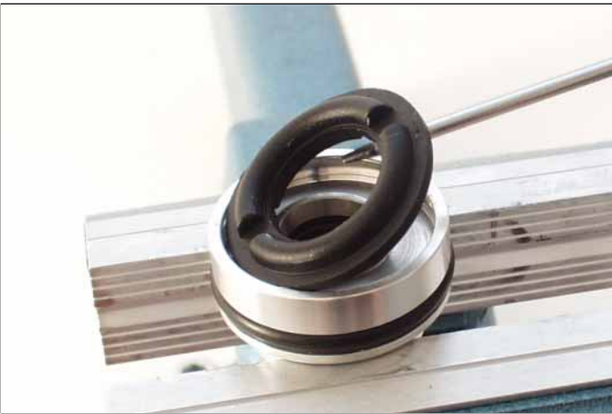
Heben Sie den Zugstufengummi aus der DU-Büchse.
